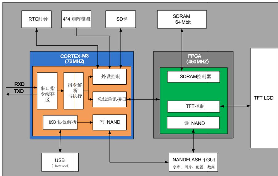
图 8-1 基本型串口屏内部结构图
